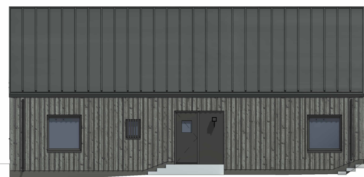
NW-GEVEL 14 1:100 Deze gevel voorzien van opklaten
