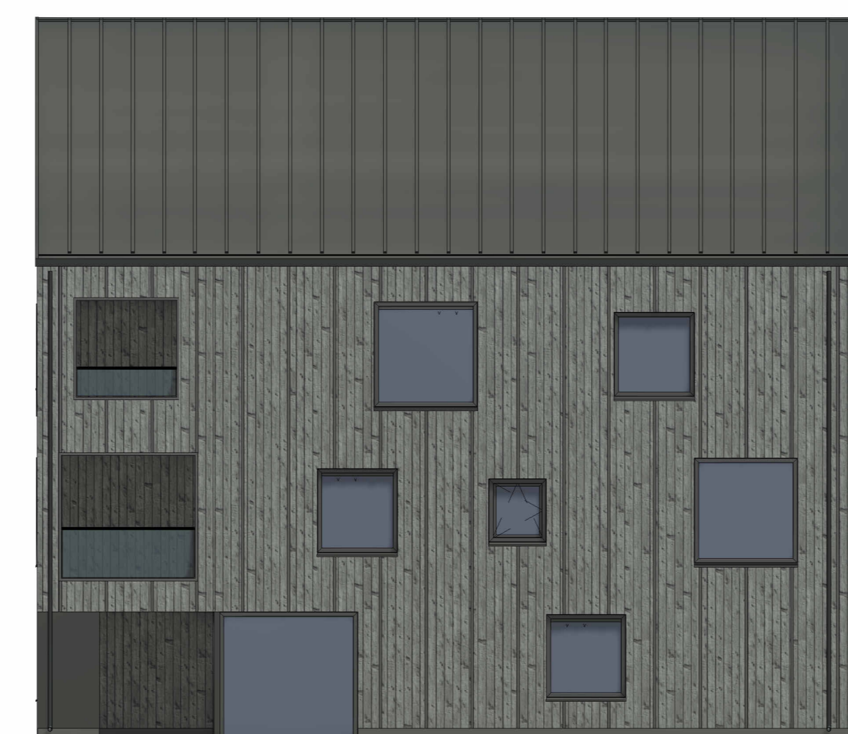
NW-GEVEL 04,05,06 1:100 Deze gevel voorzien van opklatklaten
