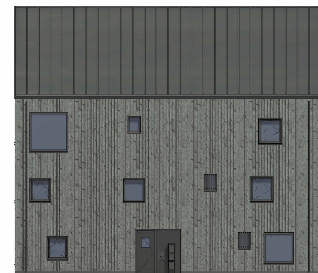
ZO-GEVEL 04,05,06 1:100 Deze gevel voorzien van opklatklaten
