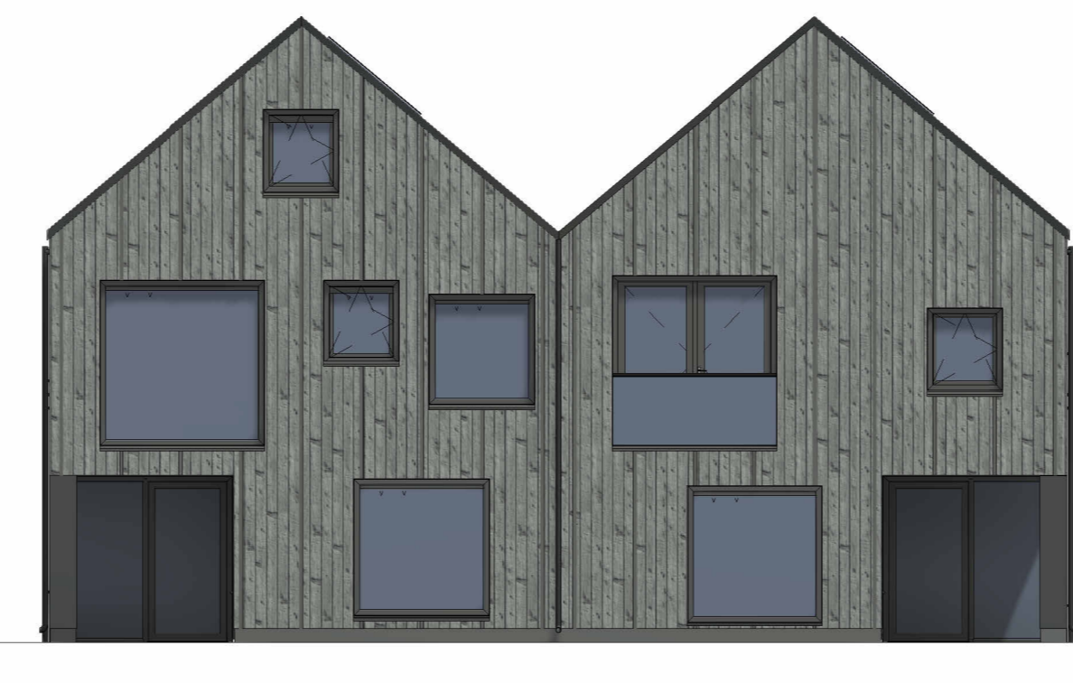
ZW-GEVEL 18 1:100 Deze gevel voorzien van opskatlatten
