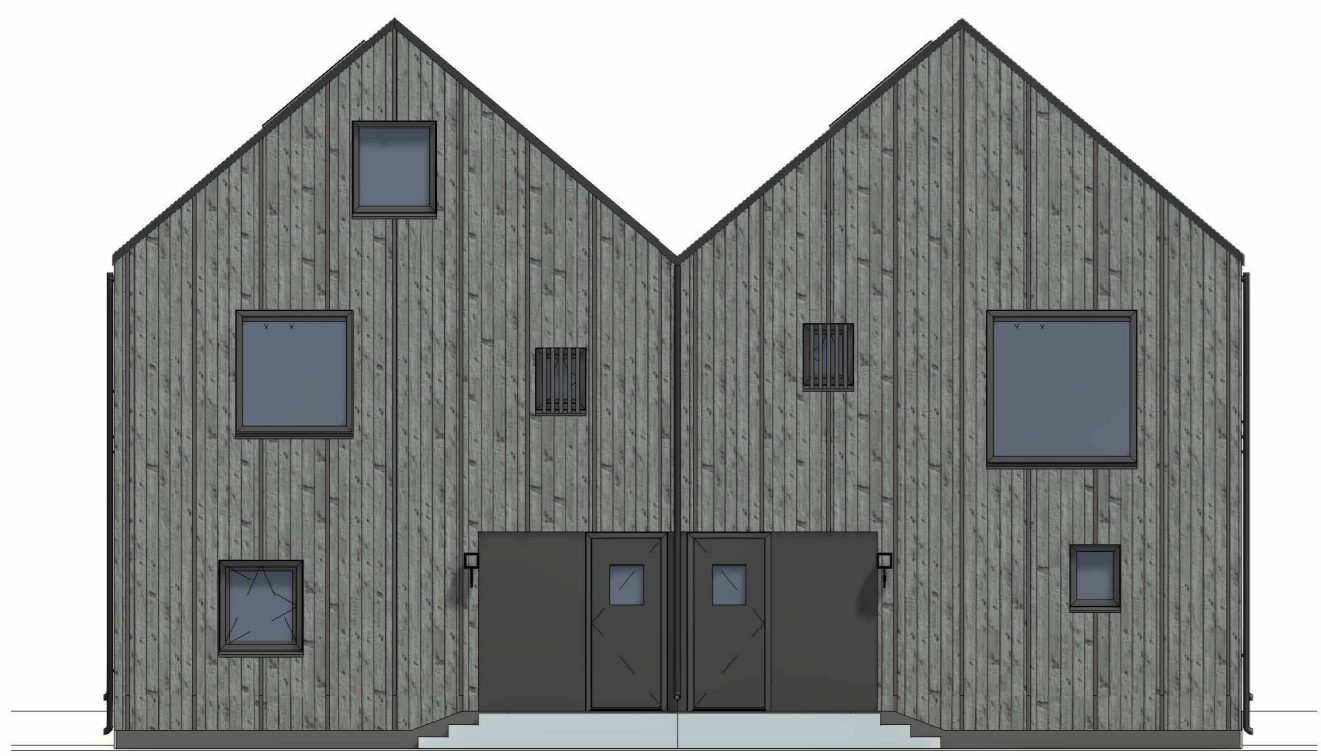
NO-GEVEL 18 1:100 Deze gevel voorzien van opskatlatten
