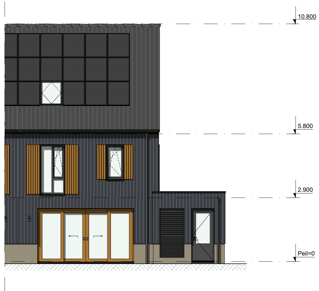
1.A.0.36 | Verlengen ongeïsoleerde berging 120 cm
