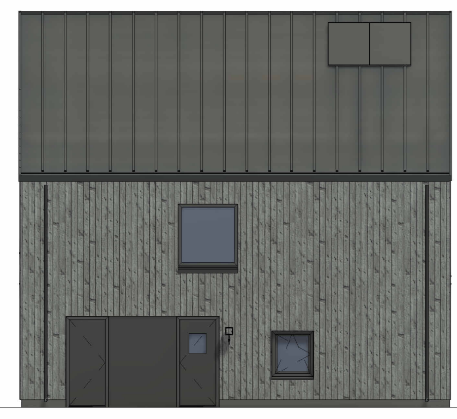
ZO-GEVEL 08 1:100 Deze gevel voorzien van opklatsten.
