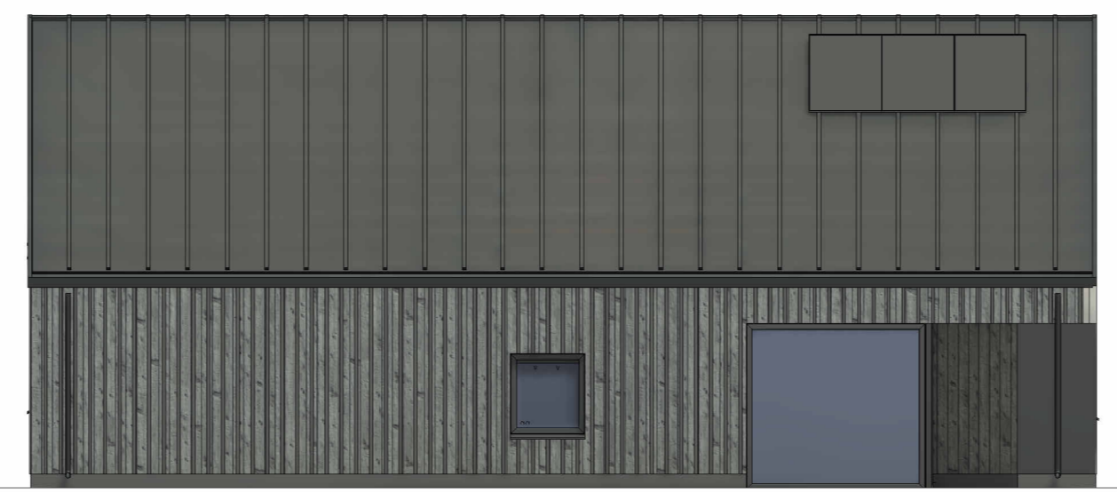
ZO-GEVEL 11 1:100 Deze gevel voorzien van opdekplaten
