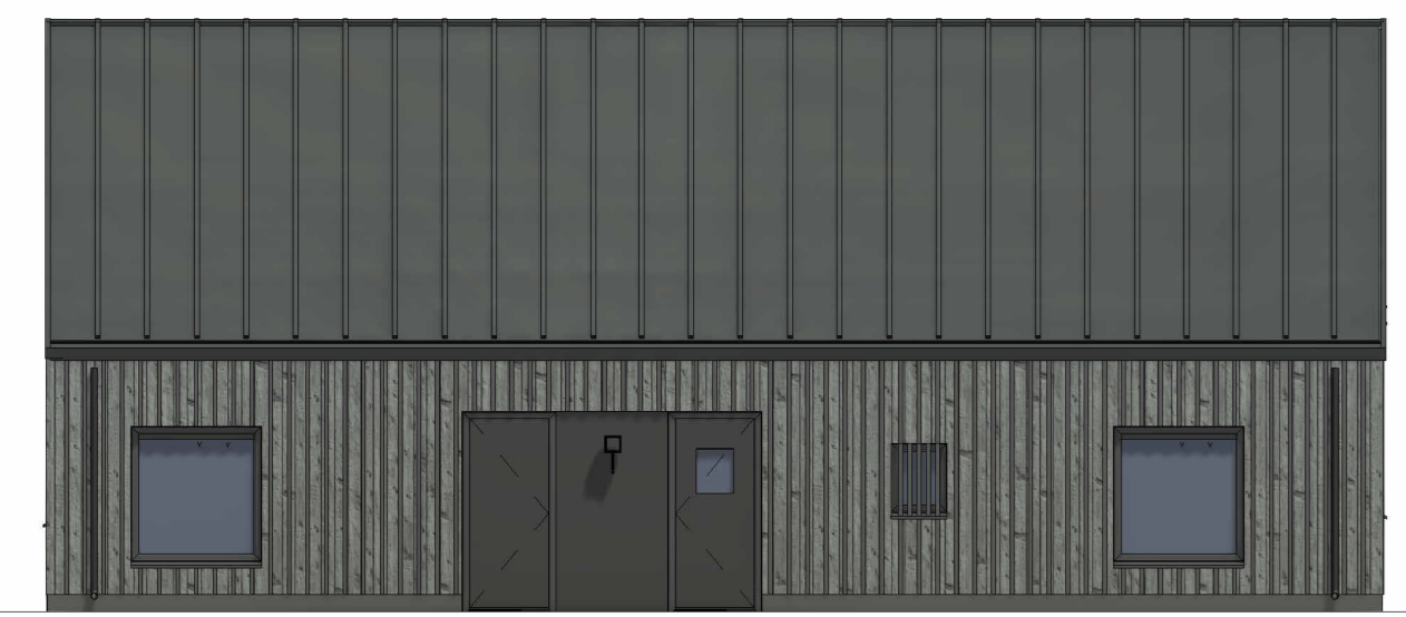
NW-GEVEL 11 1:100 Deze gevel voorzien van opdekplaten
