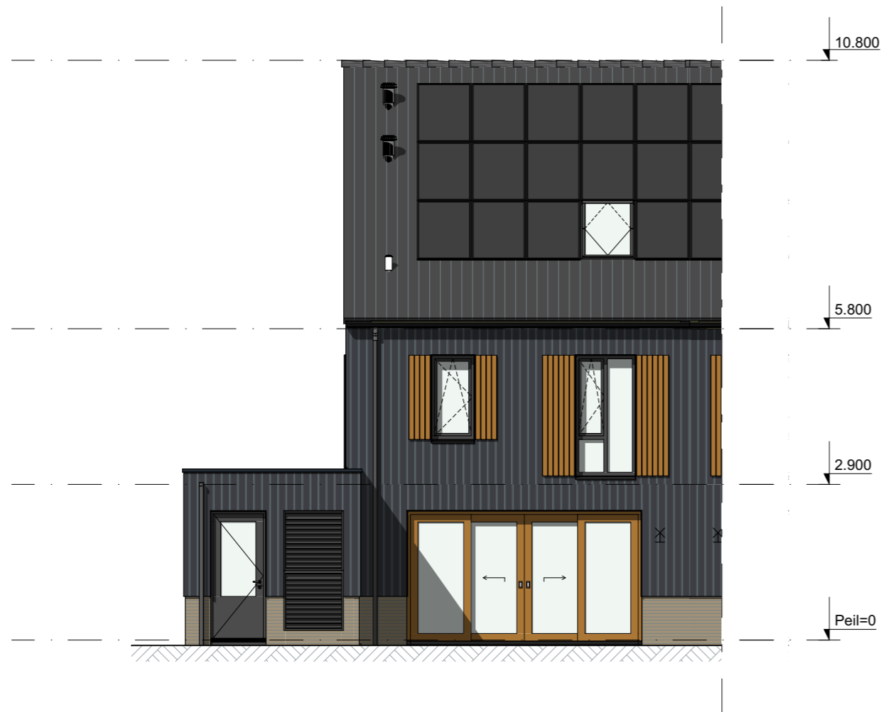
1.A.0.36 | Verlengen ongeïsoleerde berging 120 cm
