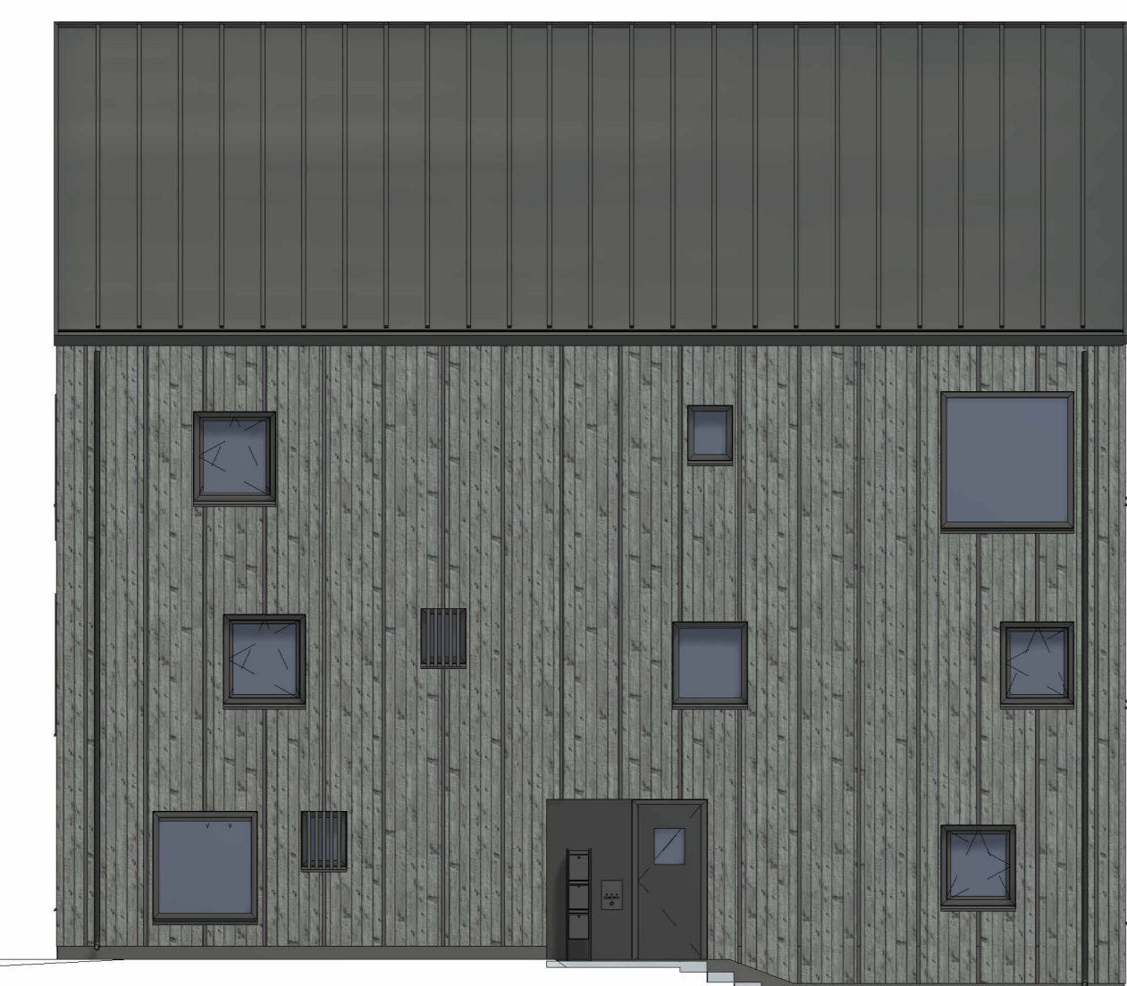
ZO-GEVEL 19,20,21 1:100 Deze gevel voorzien van opskakelaten
