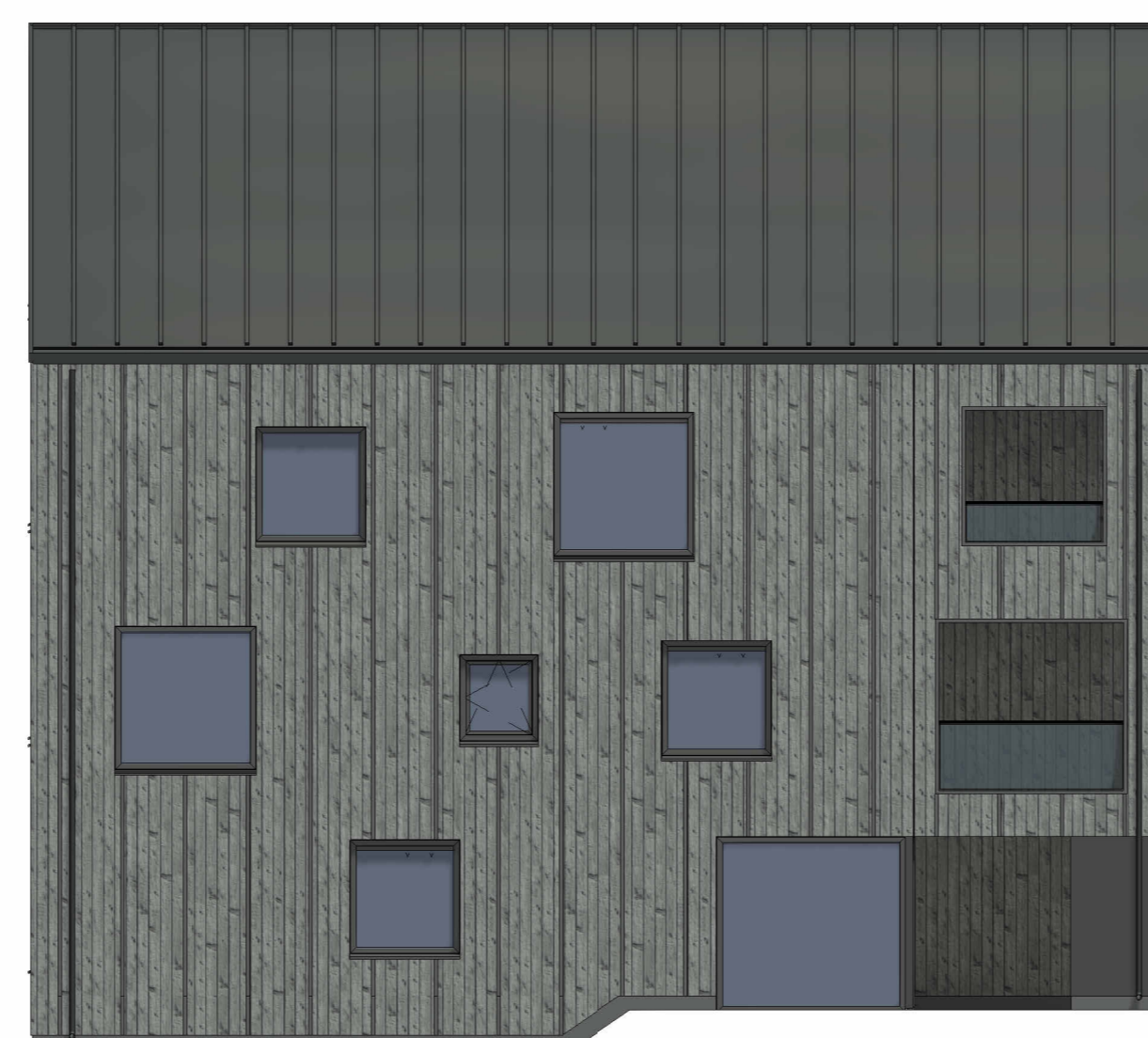
NW-GEVEL 19,20,21 1:100 Deze gevel voorzien van opskakelaten
